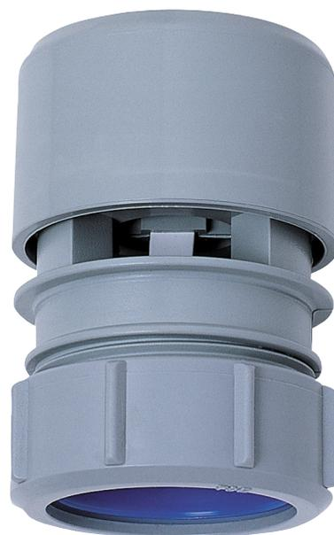
Anti-vide WIRQUIN pour installation verticale. Evite tous les désagréments liés aux dépressions dans les canalisations tel que les bruits, le désiphonage des siphons et les remontées de mauvaises odeurs en supprimant les phénomènes d'aspiration.
