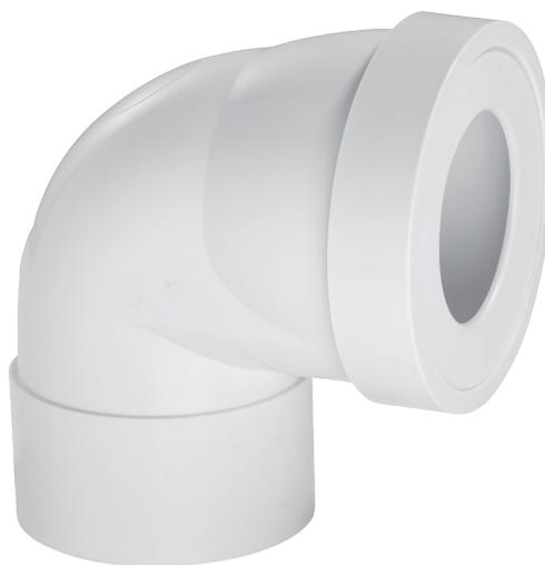
Pipe WC rigide courte, adaptée aux installations à coller grâce à sa sortie femelle. Ce produit convient pour les sorties à coller en PVC et ABS. Utilisez-le pour raccorder vos toilettes à la canalisation. Le design écoulement+, une exclusivité WIRQUIN, améliore le débit dans la pipe WC, permettant une meilleure évacuation des eaux usées.
