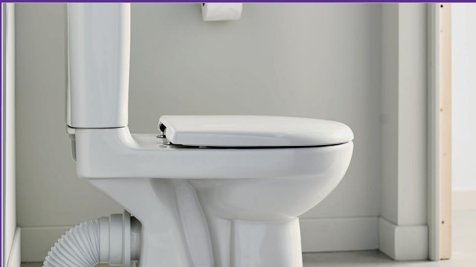
La pipe WC flexible convient pour les installations complexes, notamment pour les travaux de rénovation où la canalisation d'évacuation n'est pas accessible avec une pipe WC rigide. Cette pipe longue permet d'atteindre une distance de 500 mm entre la cuvette et la canalisation. Ce produit convient pour les installations à coller.
